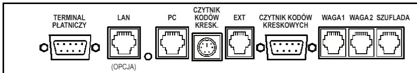
Rys. 1-2 Widok na złącza interfejsów (od spodu kasy)
